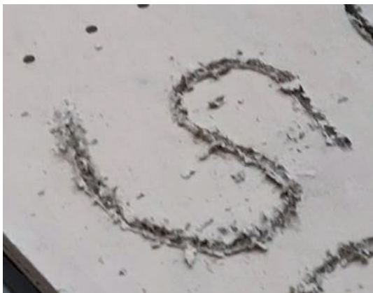
RAINURAGE AVEC UNE FRAISE CONVENTIONNELLE
