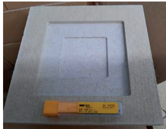
FRAISAGE DE POCHE AVEC NOS FRAISES DIXI 7306 ET FINITION 7112
