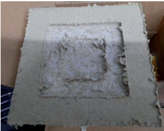
FRÄSEN VON TASCHEN MIT EINEM KONVENTIONELLEN FRÄSER
