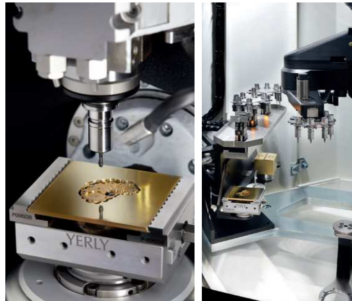
Cellule d'usinage de la Micro5 et changeur d'outils.
