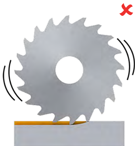
1 - 2 dents en matière Trop peu de dents = risque de vibration
