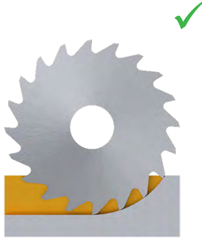
3 - 4 dents en matière = usinage stable
