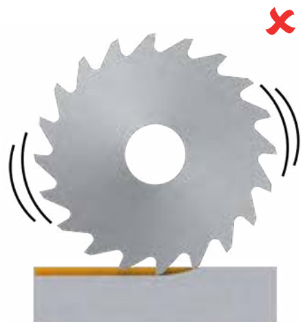
1-2齿同时切入材料，齿数太少，容易引起加工中的振动
