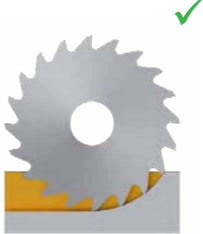
3-4齿同时切入材料，可以实现稳定加工
