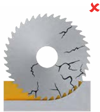
超过4齿同时切入材料，齿数过多，容易发生锯片断裂
