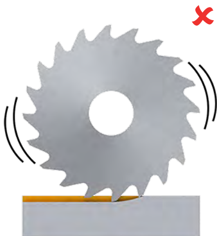
1 - 2 dientes en el material Muy pocos dientes = riesgo de vibración
