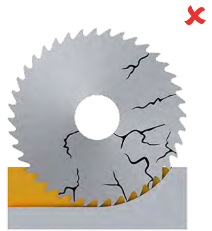
Más de 4 dientes en el material Demasiados dientes = riesgo de rotura
