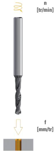
$$n \text{ [tr/min]} = \frac{Vc \text{ [m/min]} \times 1000}{\pi \times D_1 \text{ [mm]}}$$
