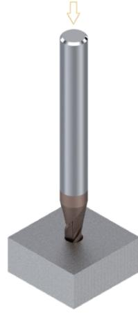
$$n \text{ [rpm]} = \frac{Vc \text{ [m/min]} \times 1000}{\pi \times D_1 \text{ [mm]}}$$
