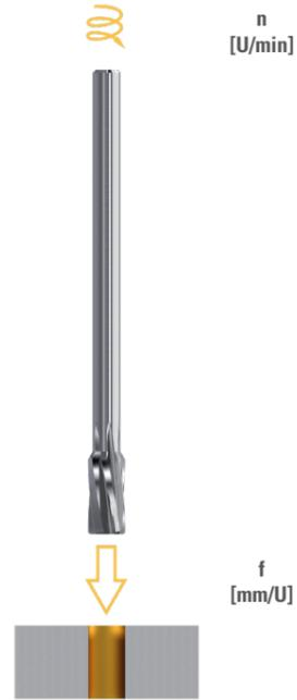
$$n \text{ [U/min]} = \frac{Vc \text{ [m/min]} \times 1000}{\pi \times D_1 \text{ [mm]}}$$
