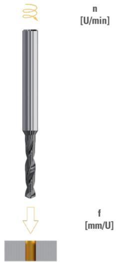
$$n \text{ [U/min]} = \frac{Vc \text{ [m/min]} \times 1000}{\pi \times D_1 \text{ [mm]}}$$
