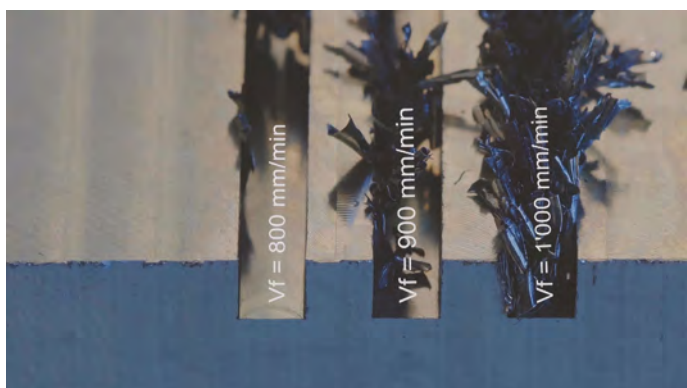
Adhésion des copeaux due à la chaleur
