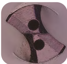
Trous \varnothing 0.15 mm Pour un foret classique
