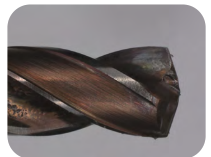
Faible usure après 23'250 perçages
