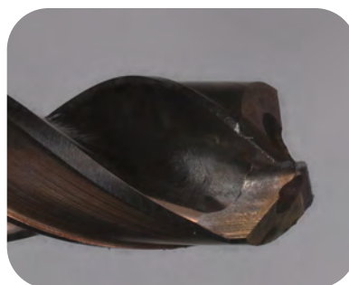
Faible usure après 23'250 perçages
