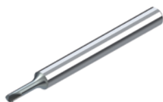
DIXI 17300 PCD M 2.50x0,45x5.8xØ3x38 Z=1 D1=Ø2
