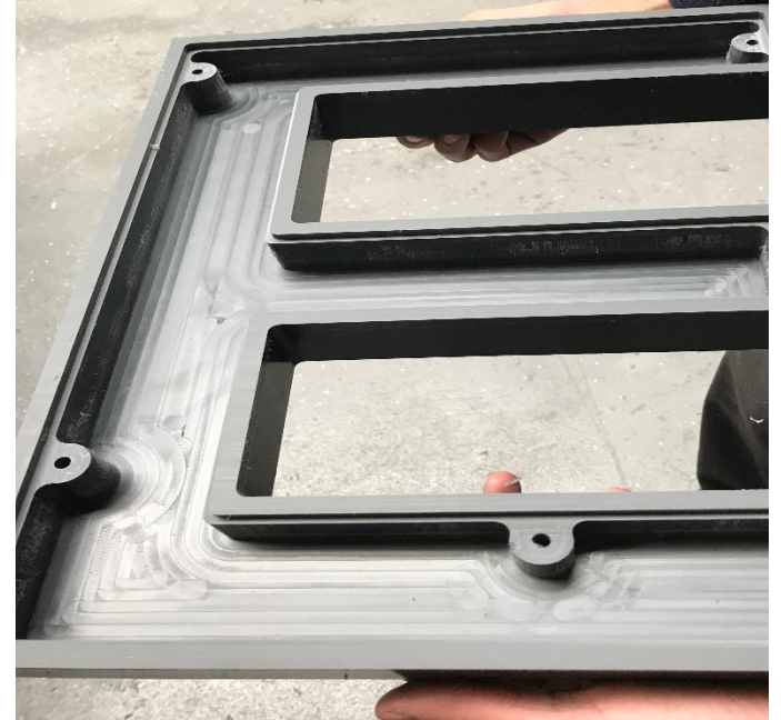
Vaciado de letras en PVC compacto con DIXI 7305 Ø6
