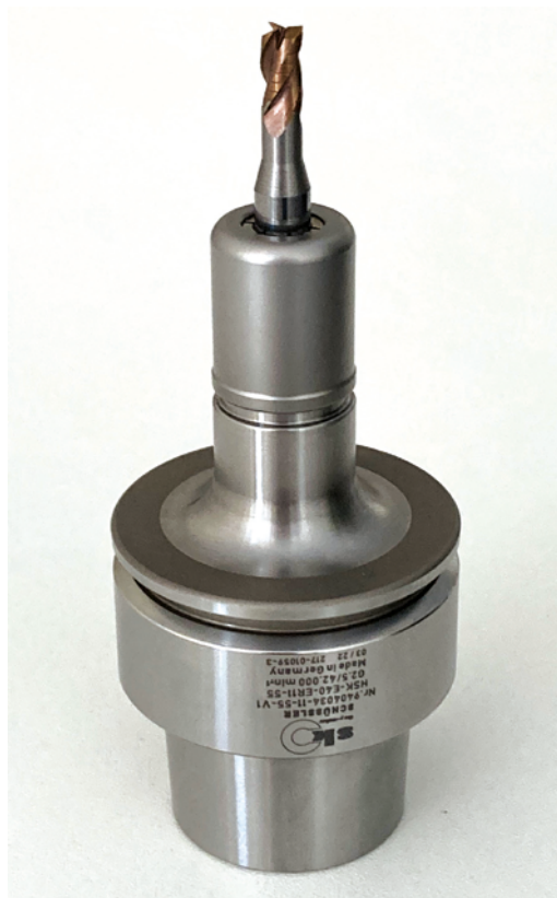
HSK- E40 con pinza ER11 Ø6.00 (fresa DIXI 7220)
