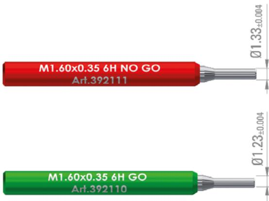
Zylindrische Vollhartmetall-Lehre zur Prüfung des Kerndurchmessers von Gewinden nach ISO 965 (DIN 13).
