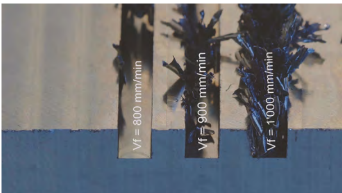
Anhaften von Spänen aufgrund von Hitze
