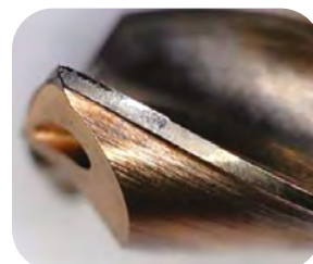
Verschleiss nach 2'200 Bohrungen
