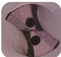
Kühlmittelbohrungen \varnothing 0.15 mit einem konventionellen Bohrer
