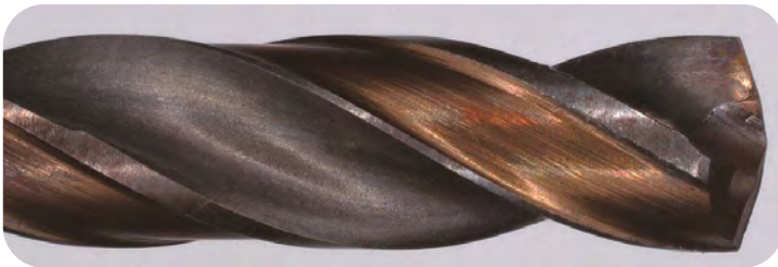
Verschleiss nach 1'000 Bohrungen
