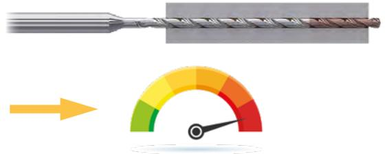
La foratura può essere eseguita in un'unica passata o con interruzioni, a seconda del materiale e del tipo di truciolo ottenuto. L'utilizzo del ciclo G73 è molto utile per dividere i trucioli, garantendo trucioli corti senza salire completamente sulla superficie del pezzo.
