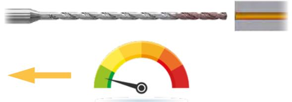
Una volta raggiunta la profondità di foratura, arretrare la punta di qualche decimo, tornare alla velocità ridotta di 500 giri/min e quindi rimuovere la punta dal foro con un avanzamento moderato di circa 800 mm/min.
