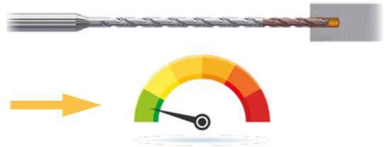
Le rotazioni elevate associate alla dentatura lunga creano un runout all'estremità della punta. Per entrare nel foro pilota e preservare le strisce di guida della punta, iniziare la lavorazione entrando a una velocità di rotazione e avanzamento ridotta, ad esempio a 500 giri/min con un avanzamento di 800 mm/min.
