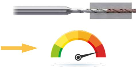
La foratura può essere eseguita in un'unica passata o con interruzioni, a seconda del materiale e del tipo di truciolo ottenuto. L'utilizzo del ciclo G73 è molto utile per dividere i trucioli, garantendo trucioli corti senza salire completamente sulla superficie del pezzo.
