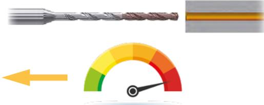
Una volta raggiunta la profondità di foratura, spostare la punta all'indietro con un avanzamento rapido.
