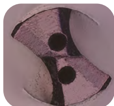
Trous \varnothing 0.15 Pour un foret classique
