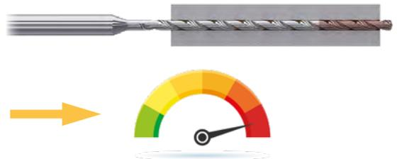
El perforado puede realizarse en una sola pasada o con interrupciones, en función del material y del tipo de viruta obtenida. El uso del ciclo G73 es muy útil para fraccionar las virutas, garantizando virutas cortas sin remontarlas completamente a la superficie de la pieza.
