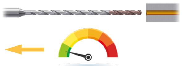
Una vez alcanzada la profundidad de perforación, retroceda la broca unas décimas, vuelva a la velocidad reducida de 500 rpm y, a continuación, extraiga la broca del orificio a una velocidad de avance moderada de unos 800 mm/min.
