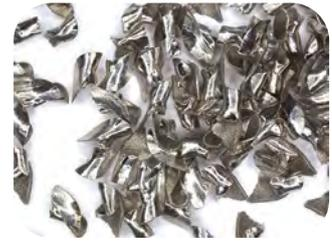
Proceso de fraccionamiento: la viruta se enrolla a lo largo del filo de corte y, a continuación, se dobla y se desgarr a lo largo del filo secundario.
