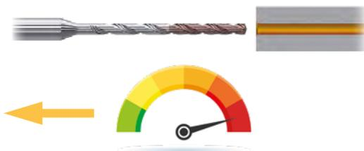
Una vez alcanzada la profundidad de perforación, desplace la broca hacia atrás a avance rápido.
