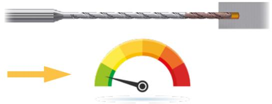
Las altas rotaciones asociadas al tallado de brocas largas crean una excentricidad en el extremo de la broca. Para entrar en el orificio piloto y conservar las tiras de guiado de la broca, comience el mecanizado entrando a una velocidad de rotación y avance reducidos, por ejemplo a 500 rpm con un avance de 800 mm/min.
