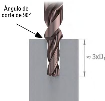
El ángulo de corte de 90° permite biselar el orificio si es necesario en el plano de la pieza. Esta característica es opcional, ya que la perforación previa a 2.5 veces el diámetro es suficiente para garantizar una ubicación precisa.
