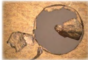
Grat am Ausgang einer Bohrung
