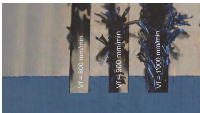
Adesione dei trucioli indotta dal calore
