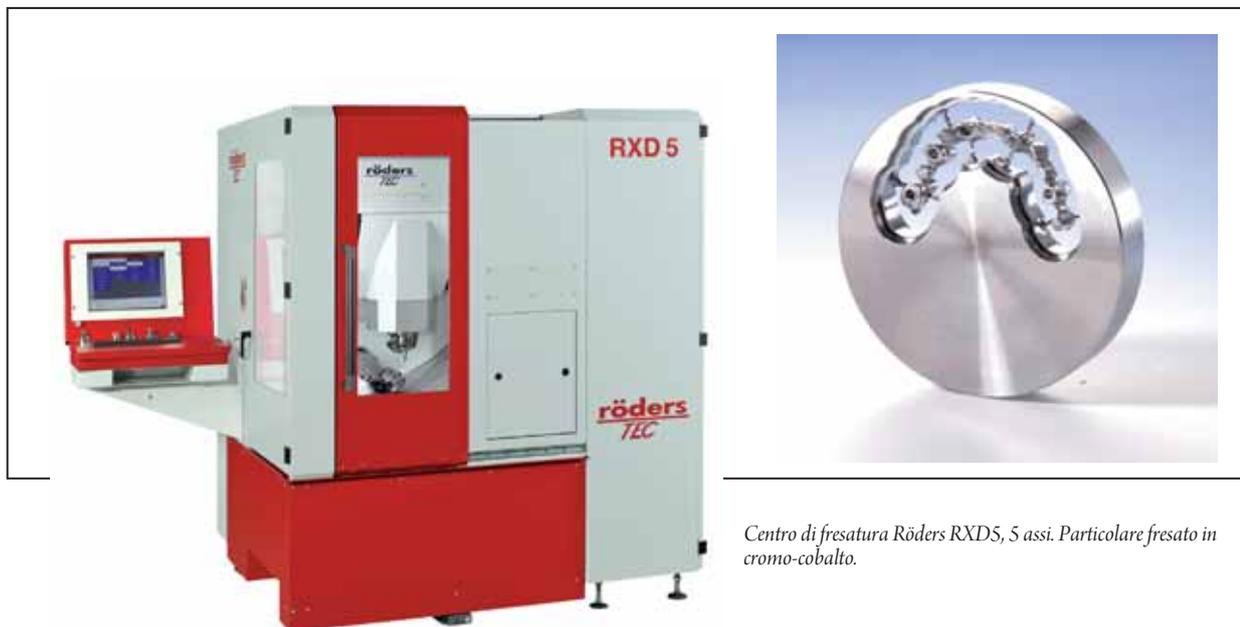
*Centro di fresatura Röders RXD5, 5 assi. Particolare fresato in cromo-cobalto.*
